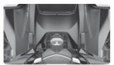
Amortecedor de Direção Hidráulico
